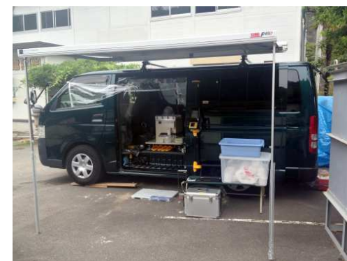
GPS連動型地中用 測定記録システム“Mogurah”
