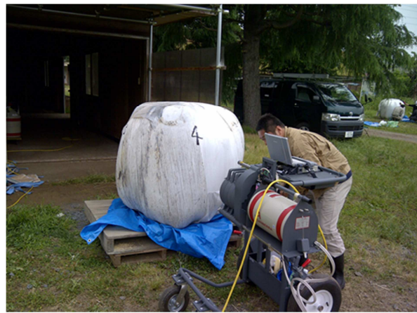
図 5 ISOCS 測定システムによる測定風景
