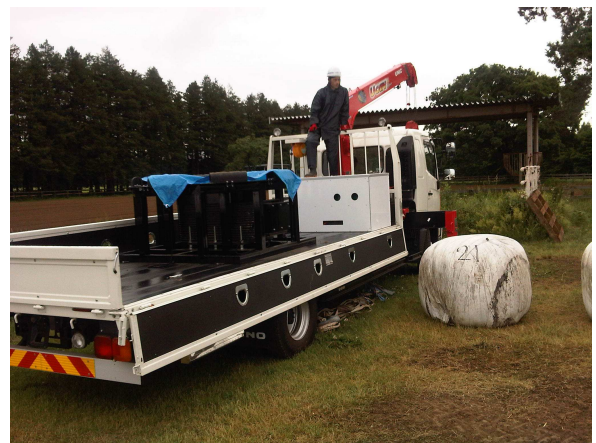
図4. フィードロール測定システム（フレコン濃度測定車）
